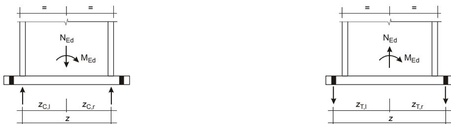
a) Assemblage de pied de poteau dans le cas d'un effort normal de compression dominant      b) Assemblage de pied de poteau dans le cas d'un effort normal de traction dominant
