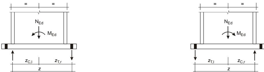
c) Assemblage de pied de poteau dans le cas d'un moment fléchissant dominant      d) Assemblage de pied de poteau dans le cas d'un moment fléchissant dominant
